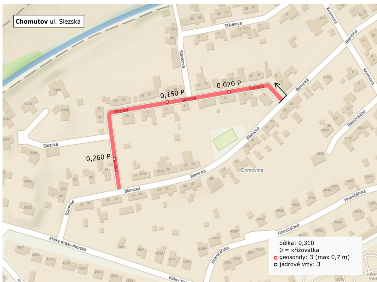
Obr. 2: Poloha jádrových vývrtů – JV, geotechnických sond – GS
